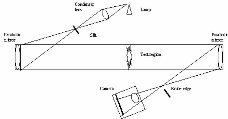
**Figure 2.7: Z-type schlieren arrangement**
